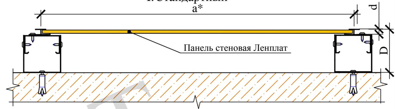
Примечание: Стандартный вариант прост в исполнении, применяется в помещениях без дополнительных требований по звукоизоляции и несущей способности облицовки стены.
